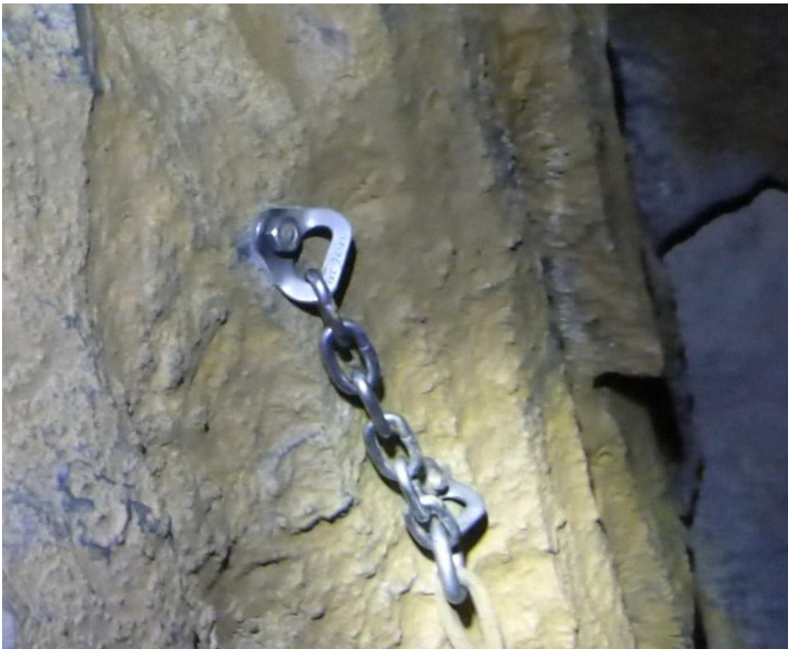
Cadena mal colocada, tira de la chapa de arriba y está torcida. El espárrago superior no asoma. Eso obliga al desgaste prematuro de la anilla al dejarla inmóvil.
