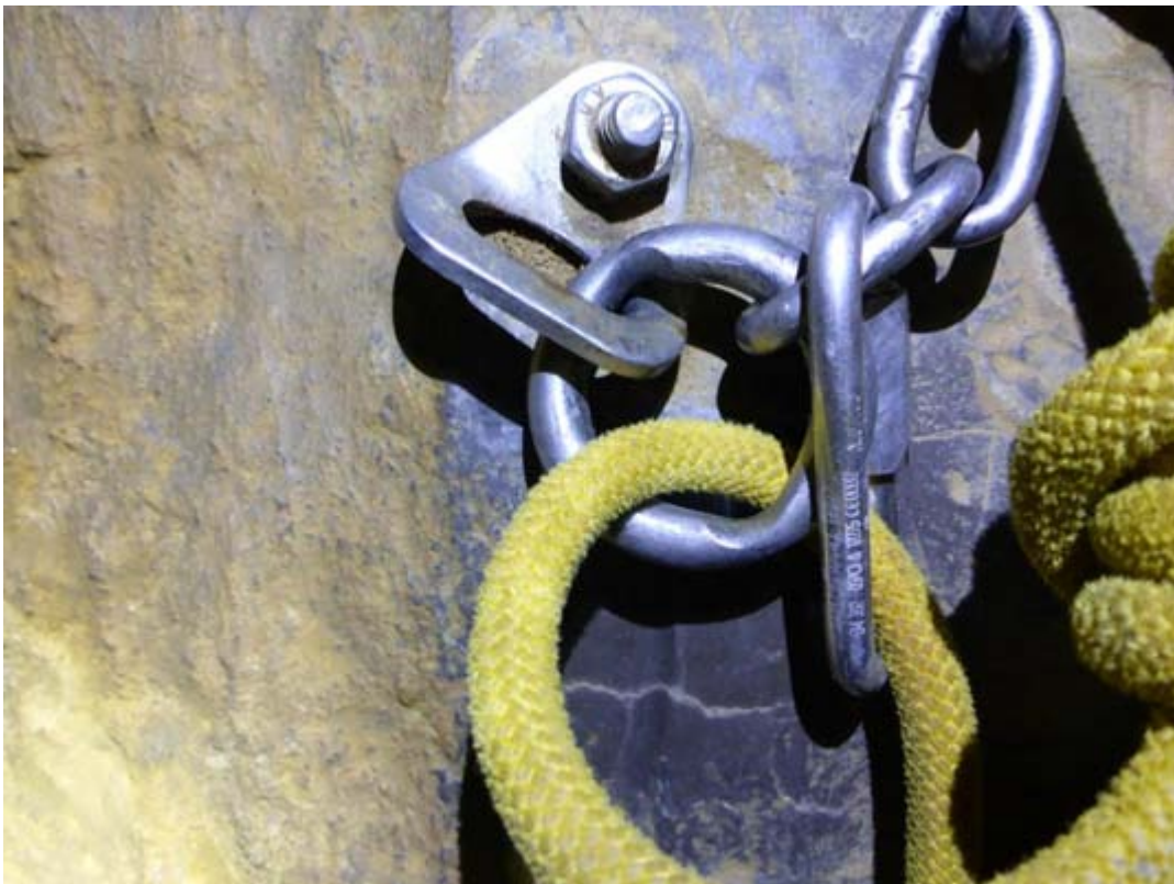
Cadena muy gastada. Primero se hizo muesca en un extremo al tirar un pasamanos de la cadena e inmovilizar la anilla. Luego la anilla rotó y se gastó el otro lado.
